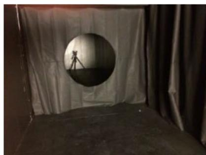
Par exemple, le LabSpion peut mesurer des luminaires avec une longueur/diamètre maximum de 150 cm, de sorte que la taille du faisceau lumineux à mi-chemin entre le capteur et la lampe sera de 75 cm. Par conséquent, un déflecteur léger placé à mi-chemin doit avoir un diamètre de  $75+25$  cm pour compenser les petites erreurs d'installation.
