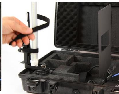
4) Utilisez des sangles Velcro pour maintenir le luminaire. Ne couvrez pas les 8+ cm du milieu. Cette section contribue à la mesure telle qu'elle est dans le champ de vision du capteur.
