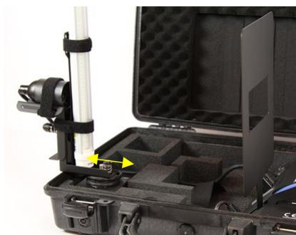
5) Centrez la source lumineuse. **Il est très important de centrer la source lumineuse sur le centre de rotation du goniomètre.**
